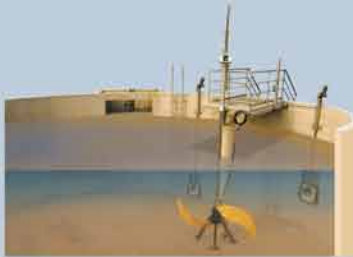
Bio-P-Becken: Mikroorganismen lösen Phosphat aus komplexen Verbindungen.
