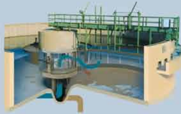
Nachklärbecken: Abwasser wird vom Schlamm getrennt.
