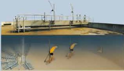
Belebungsbecken: Mikroorganismen binden gelöste Stoffe in Schlammflocken.
